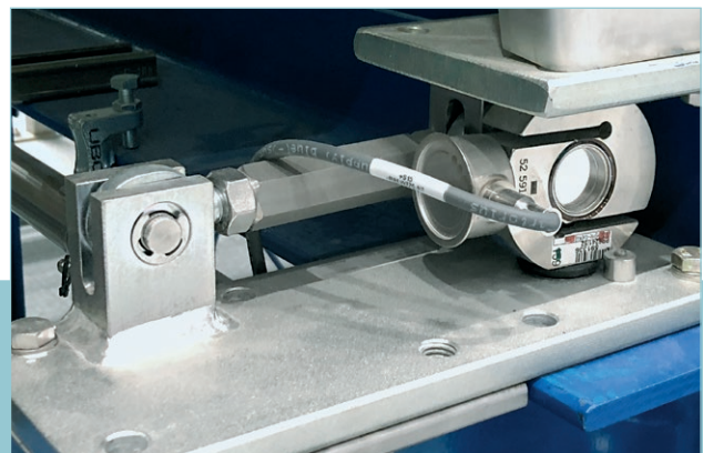
Die Drucklast S-Type Wägezellen unter den Additiv-Containertanks bieten hochpräzise Messergebnisse
