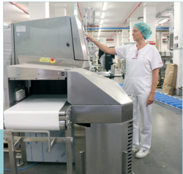
Das Röntgeninspektionssystem Dymond ist bei Anona am Ende der Produktionslinie als kritischer Kontrollpunkt fest implementiert
