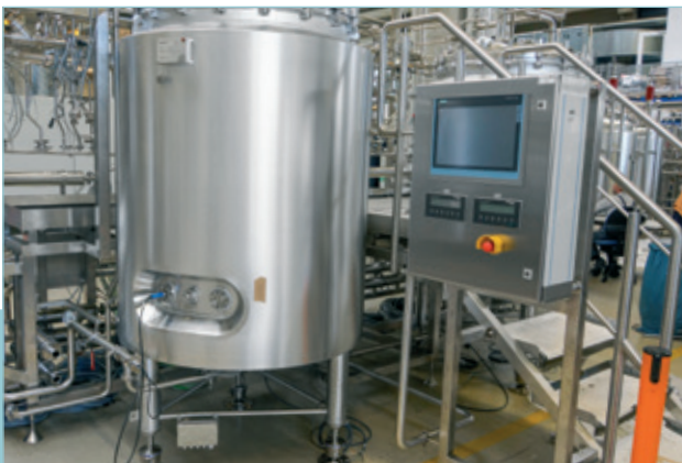
L'installation du module de pesage s'est faite en simplement grâce au réglage intégré de la hauteur du Novego.
